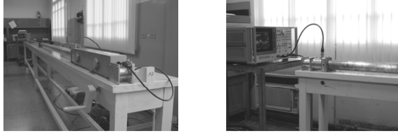
图 4 耦合损耗实际测量系统
